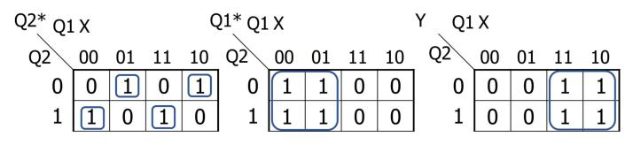
$\mathbf{Q2}^{*} = \mathbf{Q2}\overline{\mathbf{Q1}}\overline{\mathbf{X}} + \overline{\mathbf{Q2}}\overline{\mathbf{Q1}}\overline{\mathbf{X}} + \mathbf{Q2}\mathbf{Q1}\overline{\mathbf{X}} + \overline{\mathbf{Q2}}\overline{\mathbf{Q1}}\overline{\mathbf{X}}$
